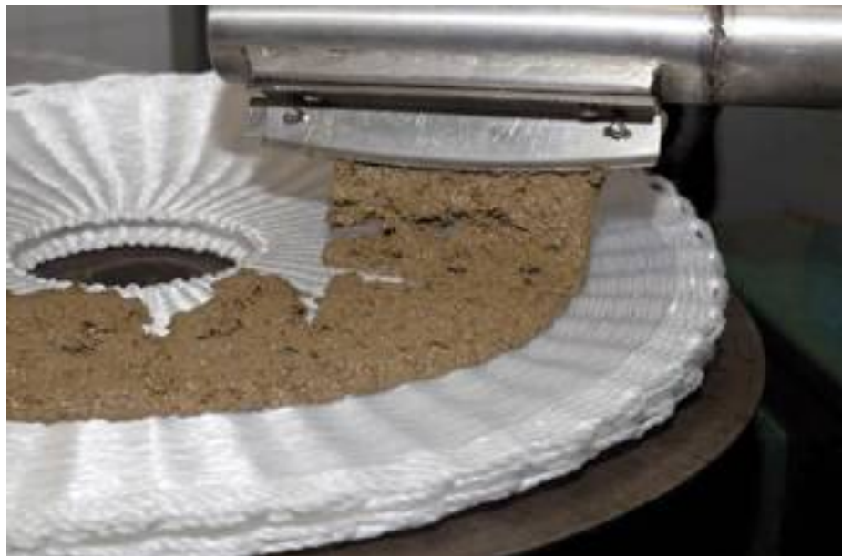
▲ Frantoio a ciclo discontinuo: preparazione dei fiscoli alla fase di pressatura.
