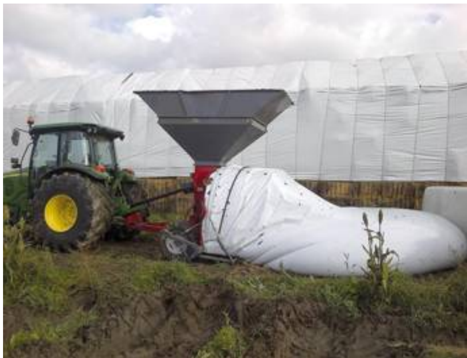
▲ Silobags per la conservazione della sansa di olive che evita fenomeni di ossidazione.
