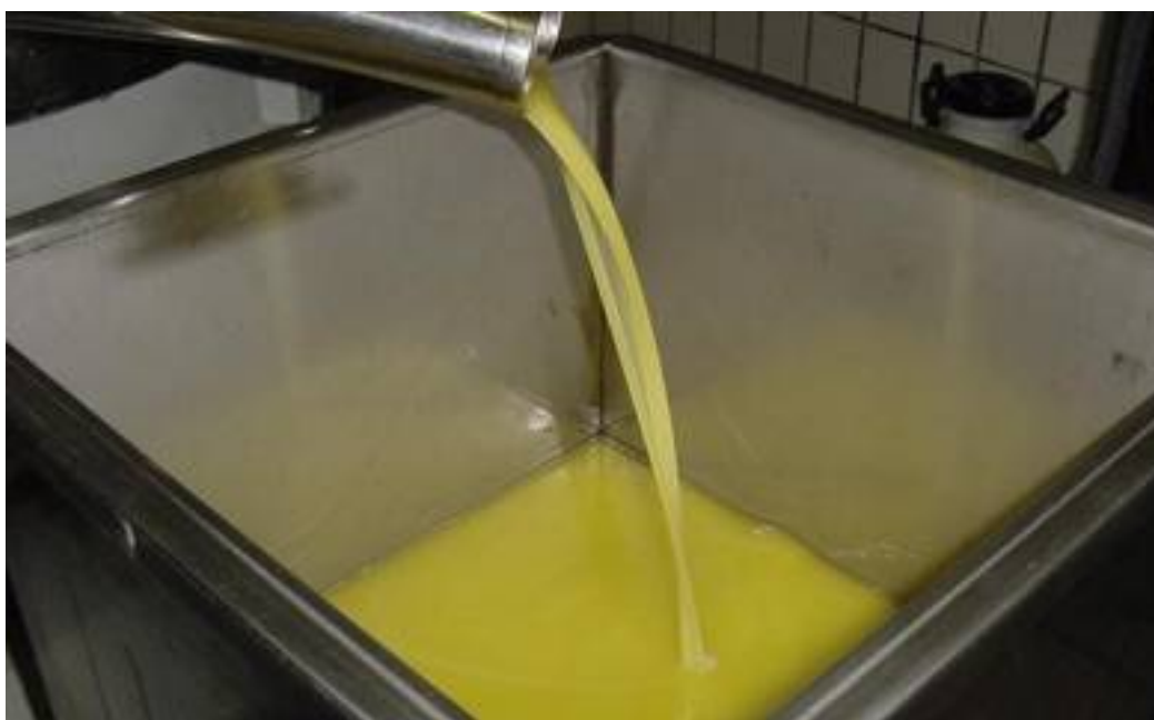
▲ Uscito dal decanter l'olio presenta una limpidezza che tende alla torbidità. A questo inconveniente si rimedia con il travaso e la filtrazione.
